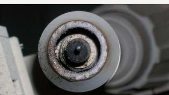
Rozdílné znečištění hubice bez povlaku a s povlakem po 75 minutách svařování
